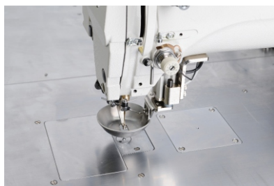
大压脚装置，压料更平整
